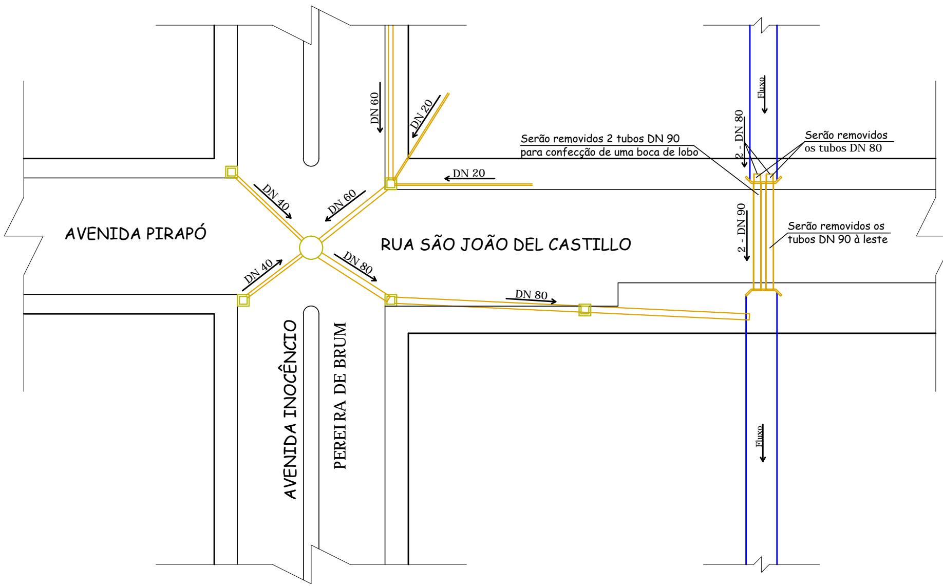
**Planta de Drenagem Existente**
